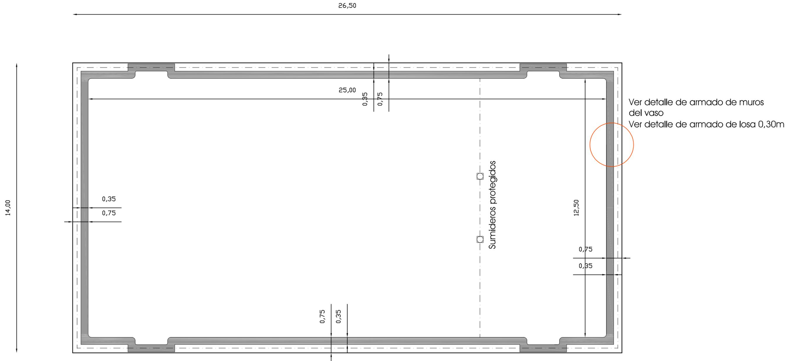
PLANTA DE CIMENTACION Y ARMADO DEL VASO
